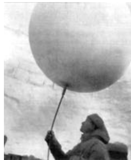
Gonflement d'un ballon de radiosondage au fond de la « tour » : les risques de vents forts imposaient un gonflement à l'abri. Pour cela on creusa dans la glace un puits de 4 mètres de diamètre et d'environ 3,5 mètres de profondeur.
